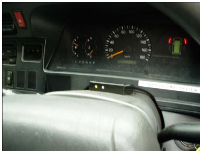
A: ステアリングコラム上部への取付け
