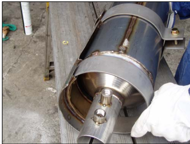
図 ブラケットの作成(上図)、遮熱板の取付け(下図)。
