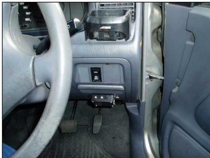
B: ダッシュボード下部への取付け
