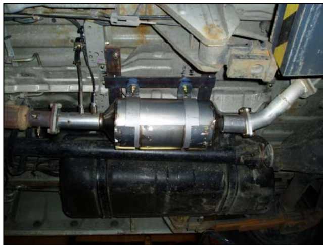
図 PMR本体搭載例(側面)
